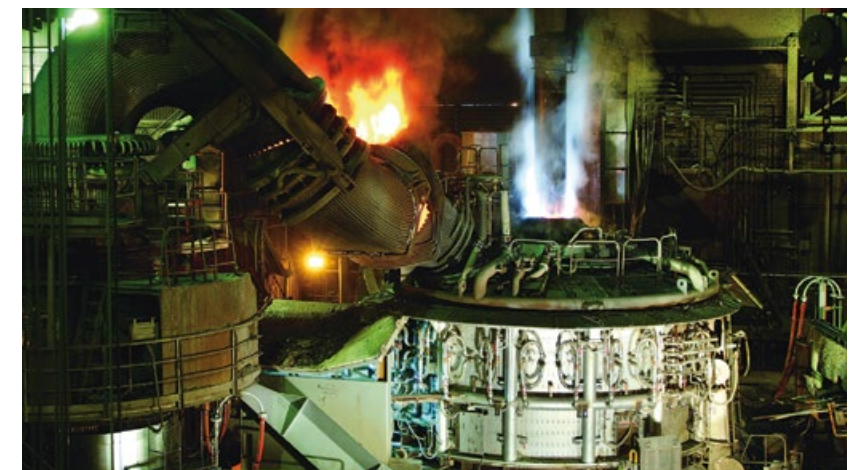
Im Elektrolichtbogenofen des Werks in Georgsmarienhütte wird Stahlschrott bei rund 1.600 Grad Celsius eingeschmolzen (Foto: Georgsmarienhütte GmbH)
